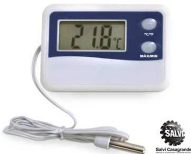
TERMÔMETRO DIGITAL, DISPLAY DE CRISTAL LIQUIDO, MAXIMA E MINIMA, INDICADO PARA MEDIÇÃO DE TEMPERATURA EXTERNA, CABO DE 500 MM (50 CM) DE COMPRIMENTO, UTILIZAÇÃO EM REFRIGERAÇÃO ESCALA DE MEDIÇÃO DE -50 + 70 °C RESOLUÇÃO 0,1 °C MODELO 7424.02.1.00. - MARCA INCOTERM.
