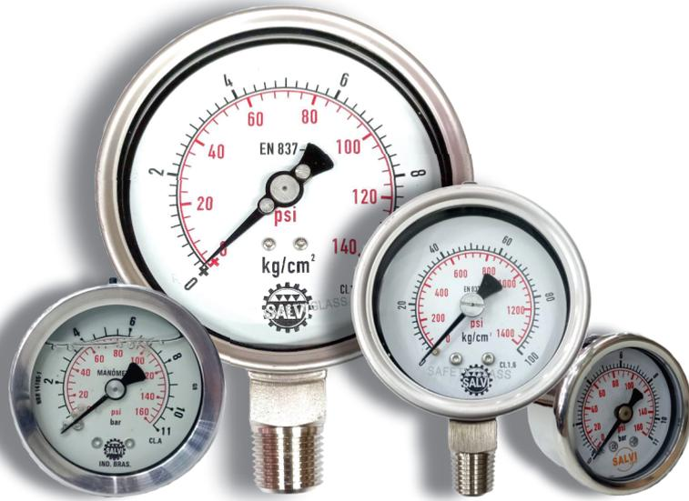
Manômetros com sistema bourdon, construídos totalmente em aço inox, também conhecidos como petroquímicos, são indicados para medições de pressão em ar, água, óleo e/ou gases, com temperatura máxima de 100°C e que irão ficar expostos ao tempo.
