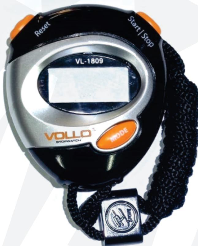
Cronômetro digital de bolso, construído com display em LCD com relógio, calendário e alarme. Tempo de medição de medição de 23 horas, 59 minutos e 59 segundos com menor leitura de 1/100 segundos.
